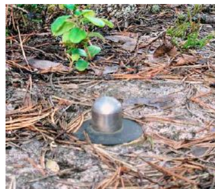
Markering med ståldubb i berg
